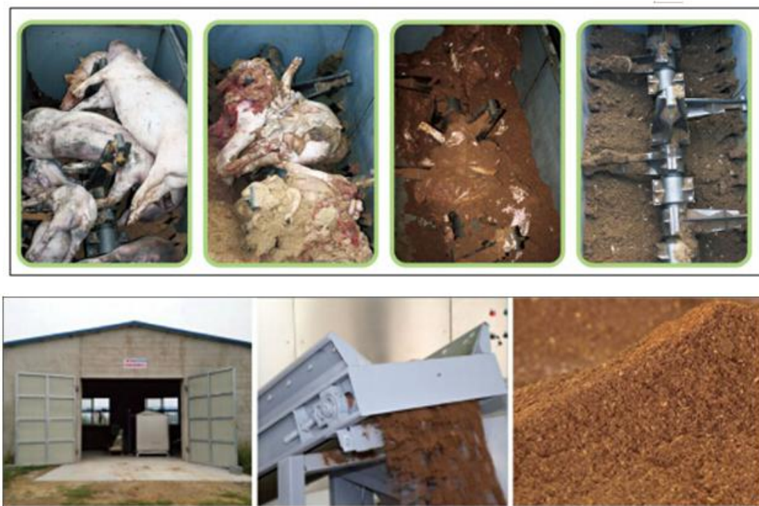
图 3-8 病死猪“高温生物发酵”技术处理实例图
